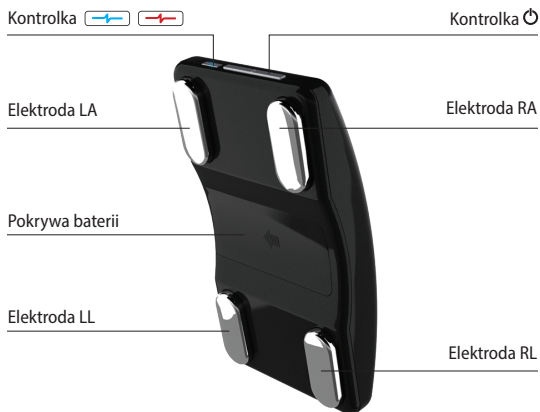
Rys. 2 Opis elementów urządzenia
